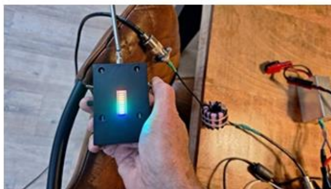
Mantelstroom filter, sniffer in de buurt van de coax. Er verandert dus niets in je antenne systeem. De mantelstromen blijven maar bereiken je set niet meer....
